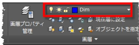
AutoCAD2016 では、DIM[寸法記入]コマンドで作図した寸法オブジェクトをシステム変数 DIMLAYER で指定した画層に自動的に配置することもできます。
