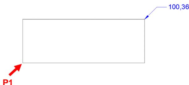
RECTANG[長方形]コマンドは、2つの対角点を指定して作図します。任意の1点目から相対座標入力で対角の座標値を指示できます。
