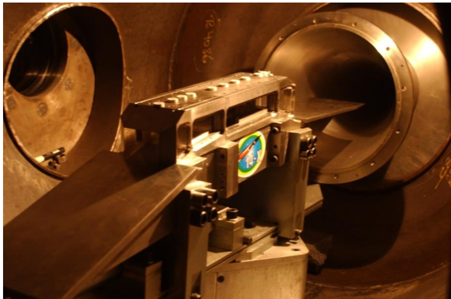
Figura 14. Modelo experimental do motor “scramjet” instalado no Túnel T3.
