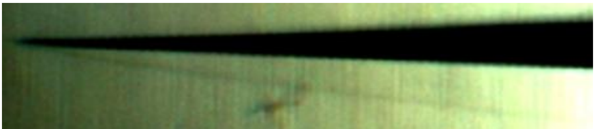
Figura 10. Fotografia “schlieren” mostrando onda de choque cônica formada no bordo de ataque.
