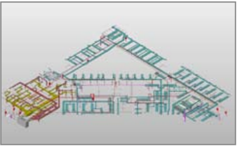
图16 Revit MEP中的MEP模型
