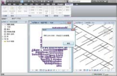
使用插件将二维线条转化为三维管道
