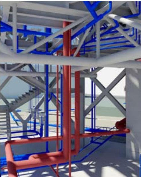
图4 结构构件、设备管线综合图
