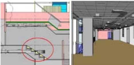
图23 建筑与设备冲突案例(世博上海案例馆)
