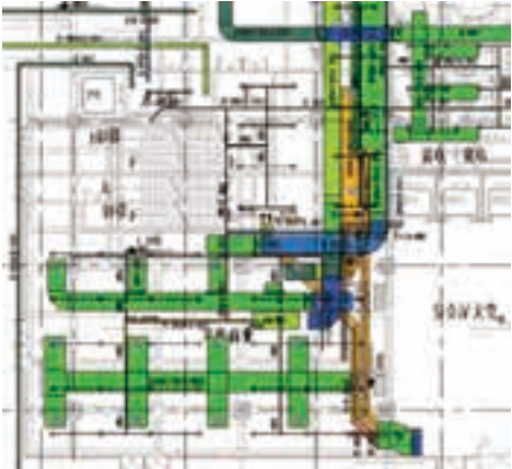
图6 管线标高层次示意图（按标高设色）
