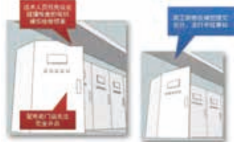
图12因操作空间需要造成的间隙碰撞
