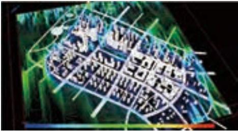
图10利用Autodesk Ecotect软件对模型进行风环境模拟
