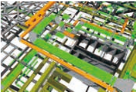
图13 基于Revit模型的裙房机电管线综合
