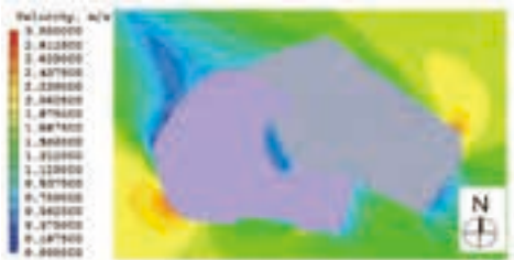
图31 人行高度1.5米处建筑周围风速云图
