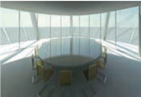
图18 Revit中对小会议室室内采光进行模拟
