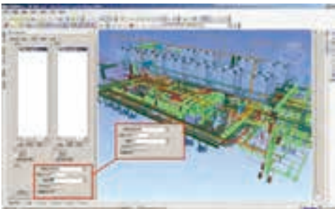
图13调整至最终显示为“零”碰撞结果
