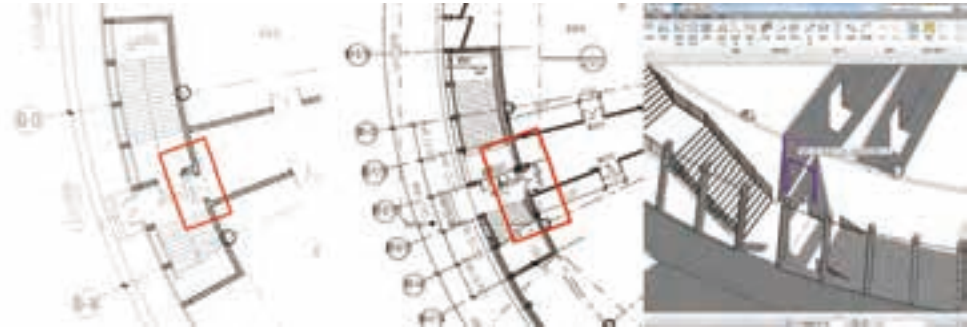
图3 扩初阶段CAD图纸、Revit导出的二维图纸、红框位置对应的墙体三维模型
