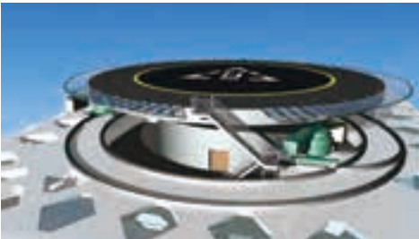
图9 基于Revit模型的擦窗机设计与优化（Navisworks整合模型）
