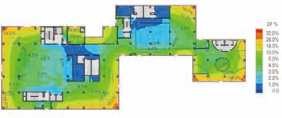
图3利用Ecotect对采光中庭和地下车库天窗自然采光效果进行分析和优化
