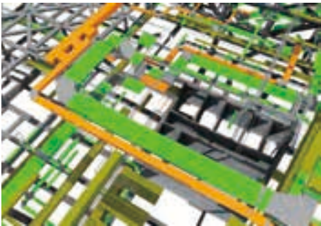
基于Revit模型的裙房机电管线综合
