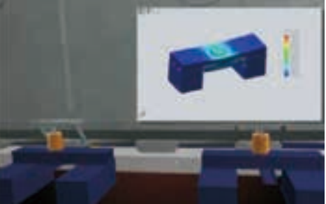
图6变压器顶推应力分析
