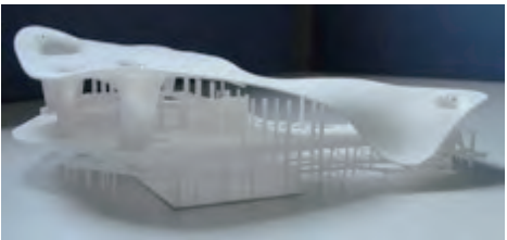
图14 基于BIM建筑信息模型的3D打印技术
