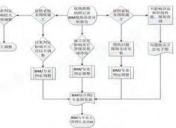
图24 现场误差分析流程图
