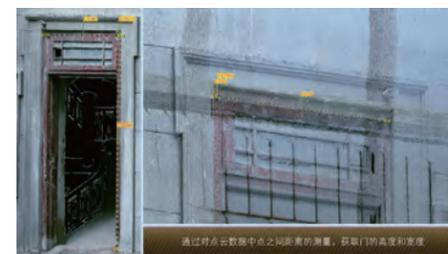
图7 点云模型中测量数据
