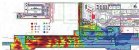
图34填挖高度分析
