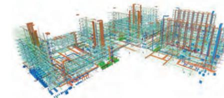
图5 Autodesk Revit机电模型
