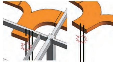
4污水立管和风管碰撞，立管移开
