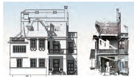
图14 比较BIM模型与被建筑点云原型的吻合程度
