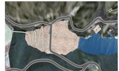
图9 上下游围堰布置
