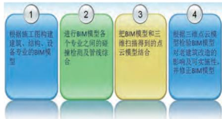
图10 BIM技术及与点云数据结合应用流程图
