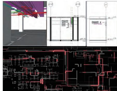
图4碰撞点三维截图及平面、剖面截图
