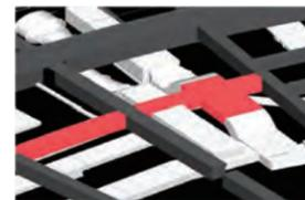
图17-1 地下一层结构梁与空调风管碰撞
