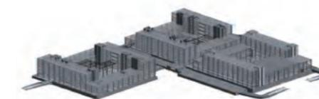
图4 Autodesk Revit结构模型
