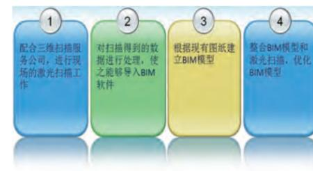
图4 三维激光扫描流程图
