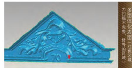
图15根据点云生成实体模型
