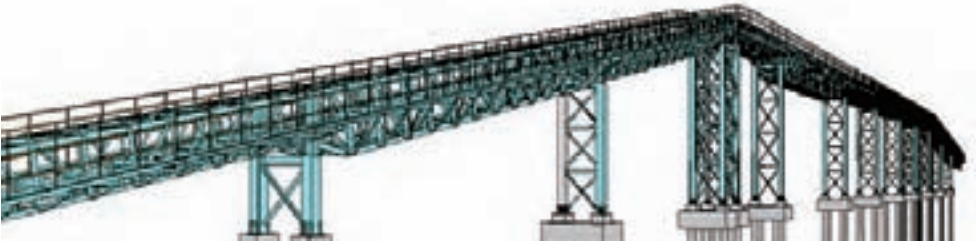
图5 皮带通廊施工图模板模型效果图
