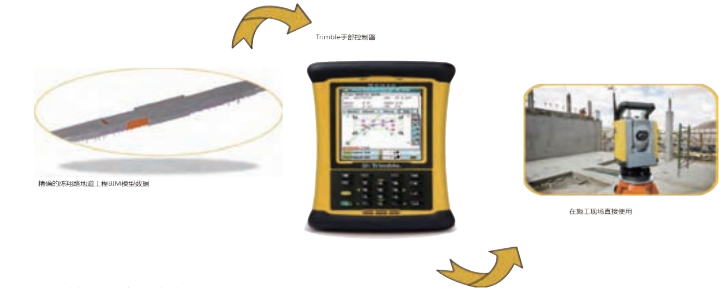
图11 BIM模型的在施工现场的自动化测量应用
