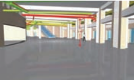
图7 台基层管线标高及排布
