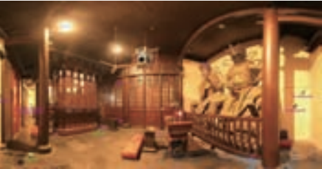
图7 天王殿室内3D激光扫描点云模型（着色）
