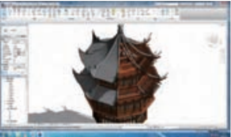
图14 古建筑构架Autodesk Revit模型
