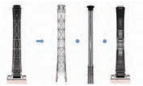
图6 在几何控制系统下生成的中国尊结构体系
