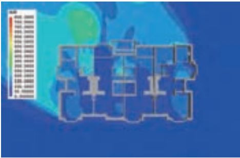
图14 四联排一层东南风空气龄（调整后）
