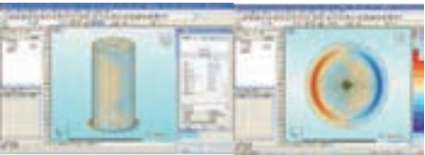
图10 沉箱模型内力计算结果
