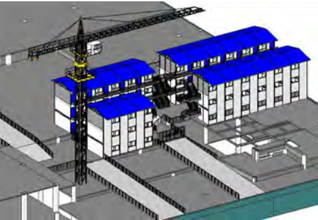
图4生活区与施工现场合理布置
