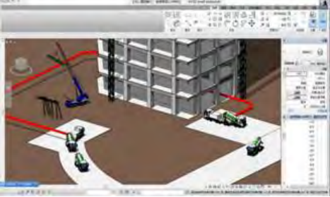
图11施工现场泵送布置
