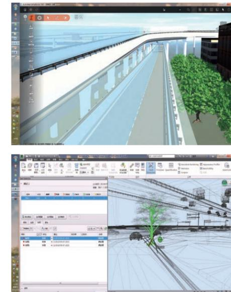
图11 实体化视距线的碰撞检查
