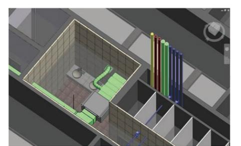
图27 BIM技术辅助孔洞预留
