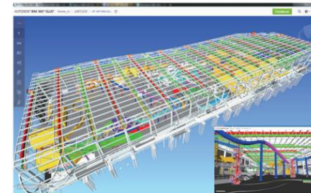
图5 项目管线模型图
