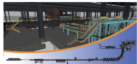
图1双流板坯连铸机效果图
