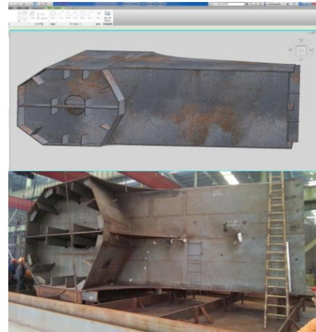
图7 Autodesk Revit 桥塔节段与工厂加工
