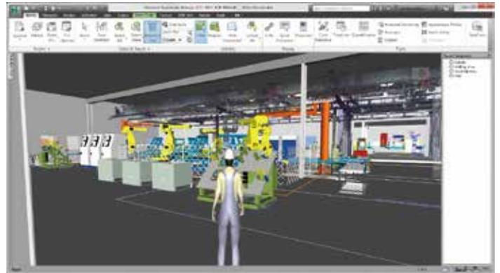
また、顧客の要求が高度化・複雑化していくなか、特に生産設備やプラント業界では、機械や設備を組み合わせるだけでなく、建物やその中の配管等のデータまで合わせて参照・計画するプロジェクトが増えつつあります。さらに、膨大なデータを集めてビューイングするだけでなく、設備との干渉を事前にチェックするなど、実務での活用も始まりました。中でも既存の工場やプラントへ新たな生産ラインや設備を導入する際のトラブルをあらかじめチェックするため、既存施設を3Dスキャンした点群データと新しい設計を用いて事前検討する手法が広がっています。
