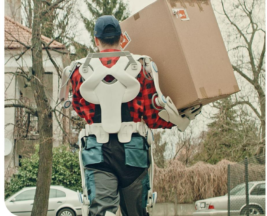
*Hier dient ein Exoskelett dem Boten als Kraftstütze beim Paketaustragen.*
