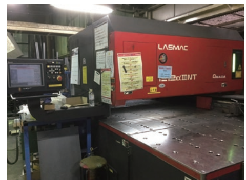
レーザーカッターによる部材の切り出し作業
