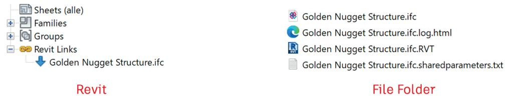
\* Le fichier \*.ifc.RVT est utilisé par Revit en interne et ne doit pas être déplacé ni modifié afin de maintenir la relation entre le projet Revit et le fichier IFC.
