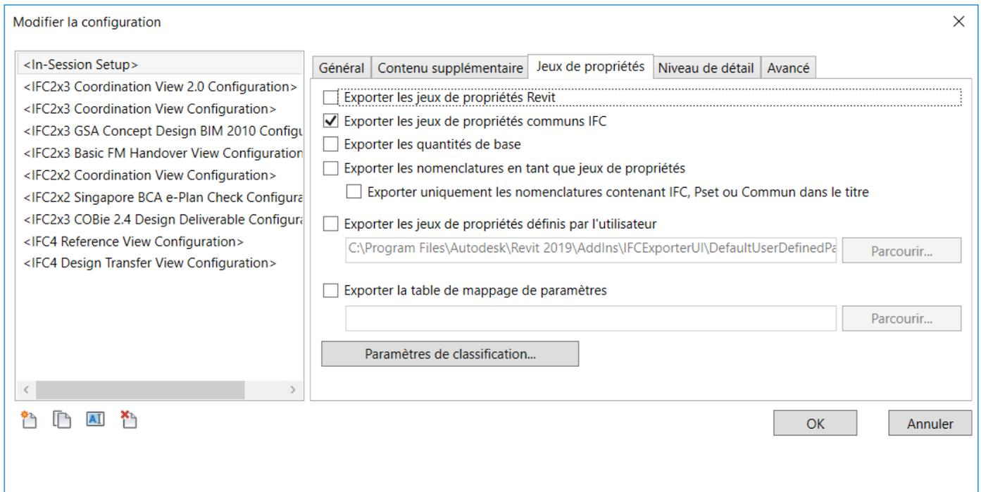
**Exporter les jeux de propriétés Revit** permet d'exporter toutes les propriétés d'un composant. Même si elle semble intéressante au premier abord, cette fonction n'est pas recommandée pour l'échange de modèles IFC spécialisés. Elle surcharge le modèle de données avec des informations inutiles, ce qui augmente considérablement la taille du fichier. Un modèle de données exporté à l'aide de cette option peut être jusqu'à 70 % plus volumineux qu'un modèle exporté via une autre méthode.
