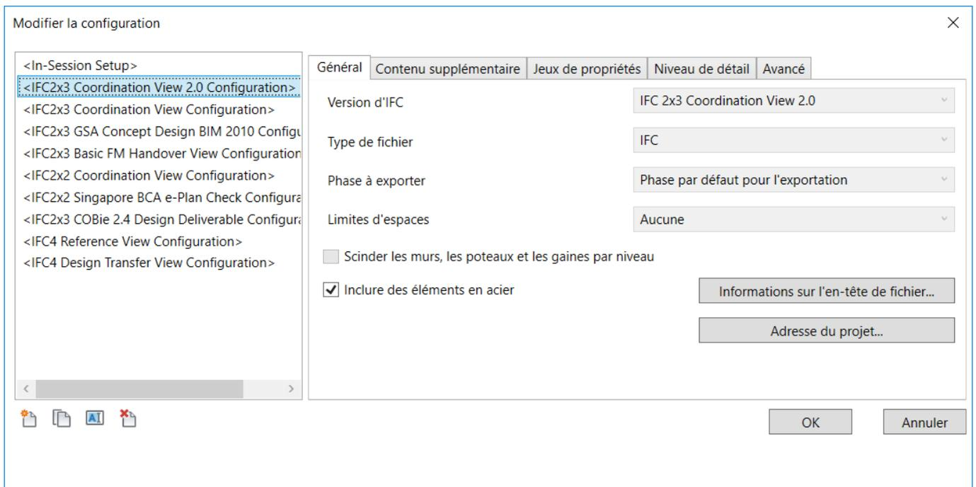
La version IFC vous permet de sélectionner le schéma IFC et le MVD, comme expliqué précédemment dans ce manuel. Le schéma le plus couramment utilisé est "IFC 2x3 Coordination View 2.0", car il est pris en charge par la plupart des logiciels du marché. Pour les géométries complexes, vous pouvez utiliser IFC4 pour bénéficier des améliorations apportées à la conversion de la géométrie, mais gardez à l'esprit qu'il s'agit encore d'une version bêta et non certifiée officiellement par buildingSMART.
