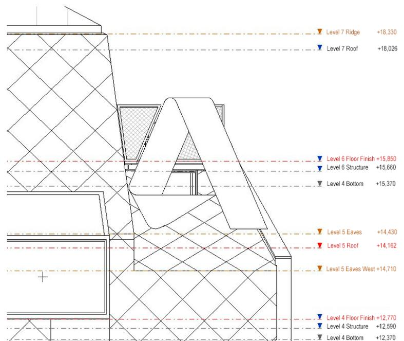
Dans l'exemple suivant, le paramètre partagé "IfcName" sert à renommer les niveaux lors de leur export. Il remplace aussi le nom prédéfini de la plupart des autres éléments Revit.
