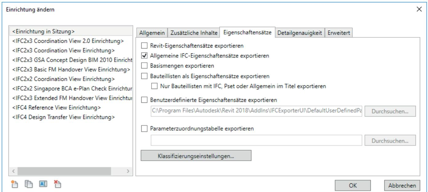
**Revit-Eigenschaftensätze exportieren** ermöglicht den Export sämtlicher Eigenschaften eines Bauteils. Obwohl das auf den ersten Blick erwünscht klingt, ist diese Funktion für den IFC-Fachmodellaustausch nicht zu empfehlen. Denn sie reichert das Datenmodell mit vielen unnötigen Informationen an und beeinflusst somit die Dateigröße negativ. Ein mit dieser Option exportiertes Datenmodell kann bis zu 70 % größer sein als ohne.
