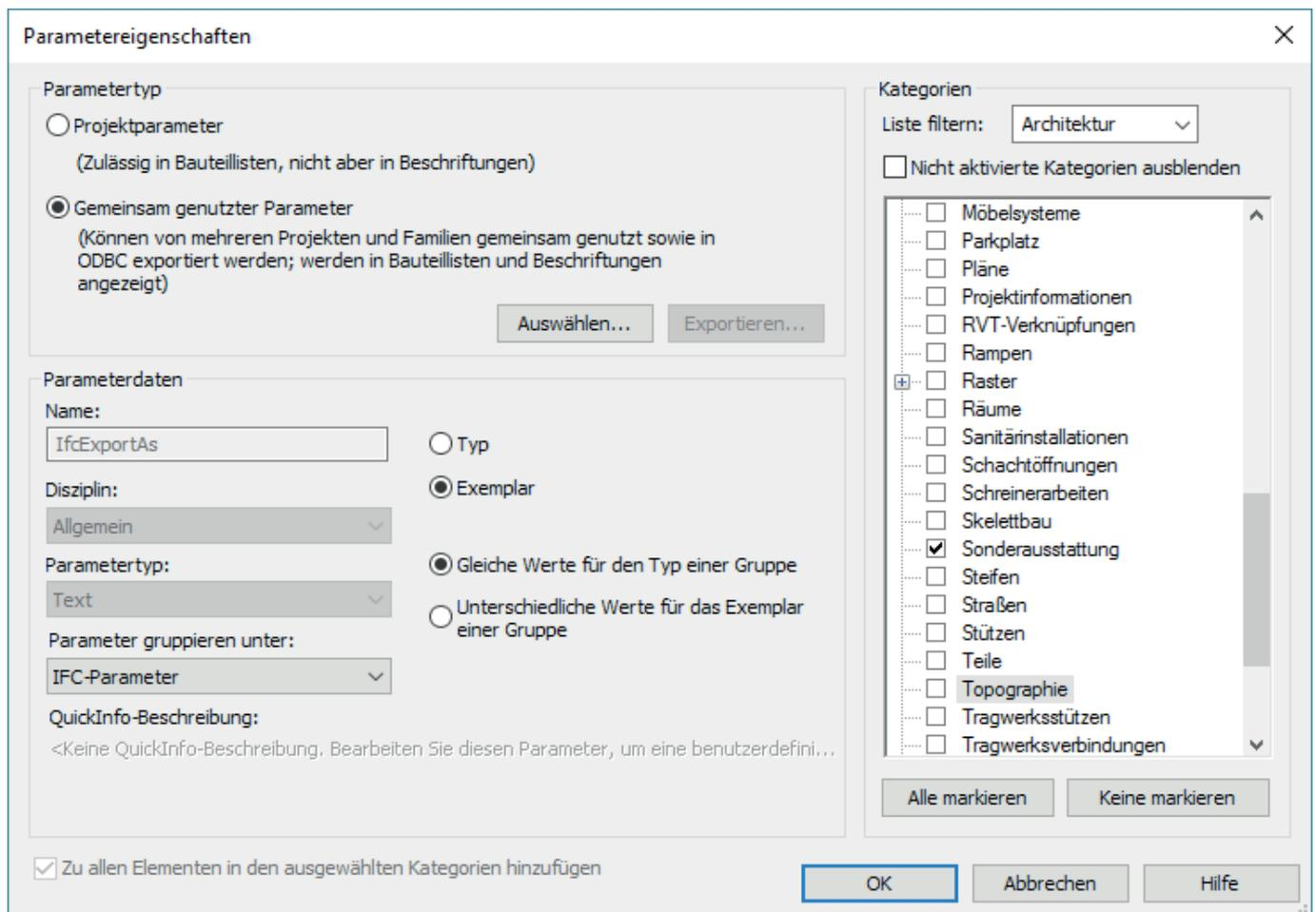
Die Parameter können je nach Bedarf und je nach Bürostandard als Typ- oder Exemplarparameter angelegt werden. In der Regel empfiehlt sich die Nutzung von Typparametern, da diese Angaben selten zwischen einzelnen Exemplaren desselben Typs variieren.
