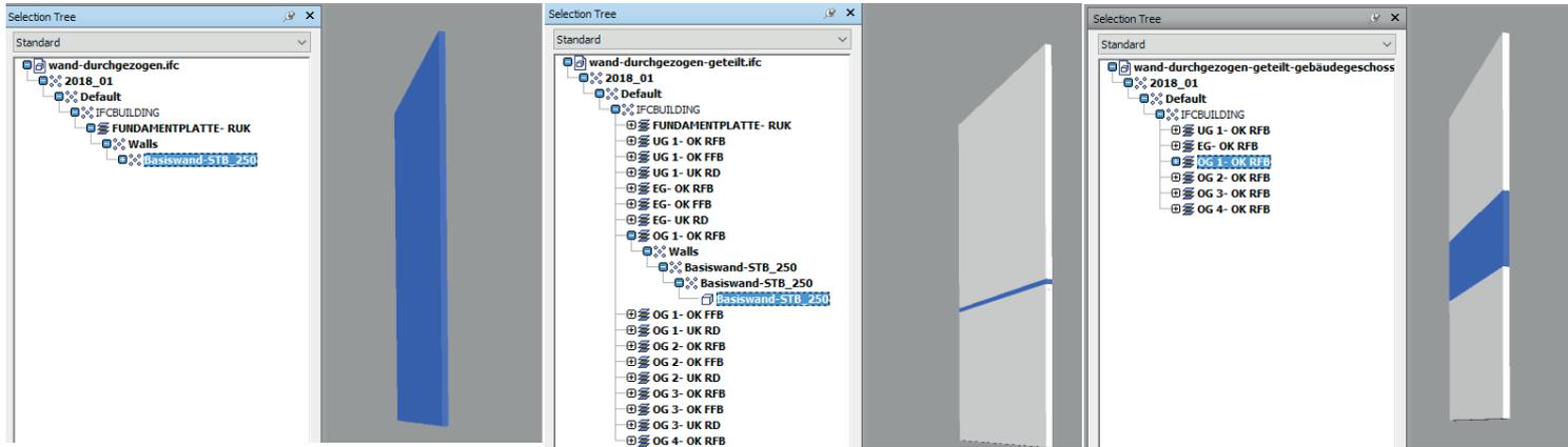
Diese Darstellung macht deutlich, wie wichtig es ist, die richtigen Ebenen als Geschossebenen zu definieren, da sonst die IFC-Struktur zu unübersichtlich wird und die Elemente auch nicht optimal geteilt werden. Idealerweise besitzt ein Projekt eine Geschossebene pro Stockwerk.
