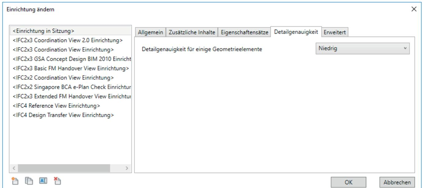
**Detailgenauigkeit für einige Geometrielemente** ermöglicht die Einstellung des Detaillierungsgrads. Dieser hat einen wesentlichen Einfluss auf die Dateigröße und die korrekte Interpretation.
