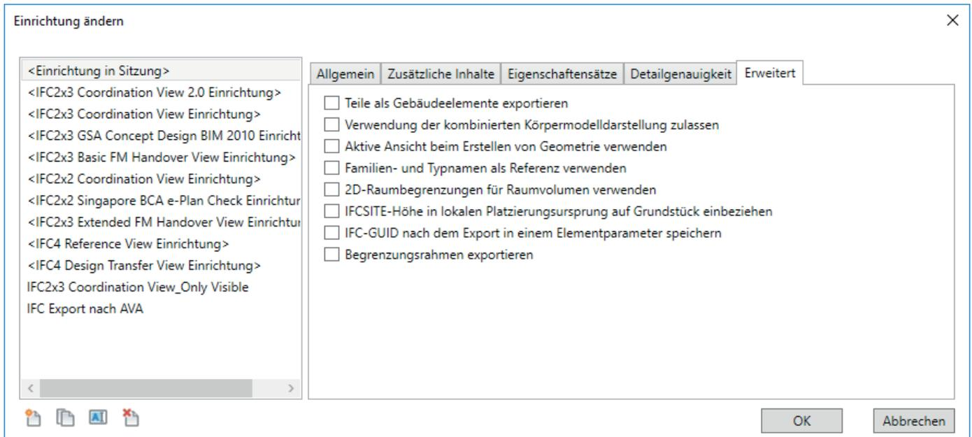
**Teile als Gebäudeelemente exportieren** ist für den IFC-Datenaustausch relevant, wenn Sie mit Teilelementen für den Aufbau von Wänden oder Decken arbeiten. Standardmäßig werden Teilelemente als „IfcBuildingElementPart“ exportiert. Das ermöglicht innerhalb des IFC-Datenmodells die Zuweisung der einzelnen Teile zu einem übergeordneten Element:
