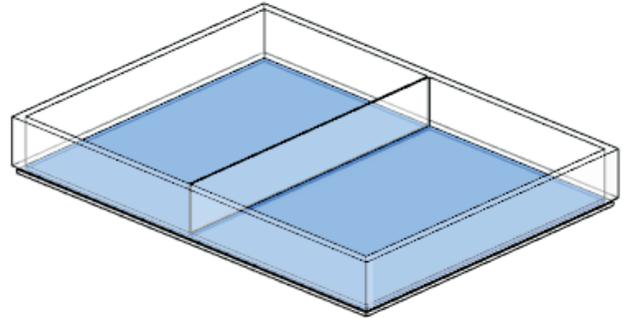
Durch diese Zuweisung erhält der Fußbodenaufbau die richtige Klasse/Typ sowie die im Pset\_CoveringCommon definierten Eigenschaften, was weitere Auswertungen erleichtert:
