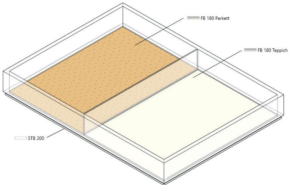
Beim IFC-Export werden standardmäßig alle Geschossdecken der Klasse IfcSlab zugewiesen. Das kann für die weitere Planung oder die Zuweisung in einer AVA- oder Berechnungssoftware hinderlich sein oder zu Fehlkalkulationen führen. Stattdessen ist es sinnvoll, den Fußboden nicht als IfcSlab, sondern als IfcCovering zu exportieren, wodurch er auch die entsprechenden Attribute zugewiesen bekommt, etwa die Entflammbarkeit oder Oberflächengüte.
