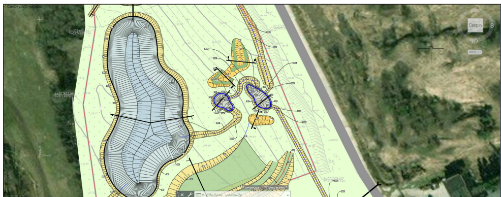
Трассировка каналов, выполненная в Autodesk Civil 3D. Изображение предоставлено бюро «Землематика»
