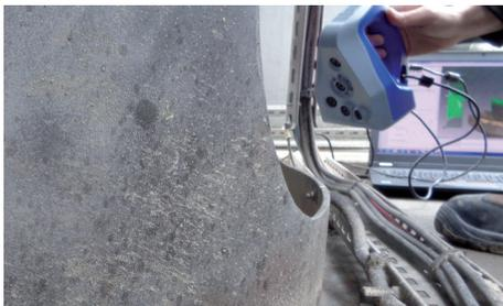
Étude mécanique : relevé scanner 3D / Technologie ARTEC sur site industriel
