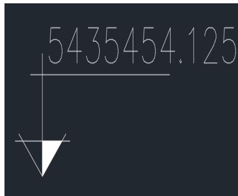
Figura 215. Elevación en secciones/alzados.
