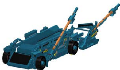
Samobieżna Zwrotnia Kołowa SZK-SZAKAL. Projekt wykonany w SIGMA S.A. przy wykorzystaniu rozwiązań Autodesk
