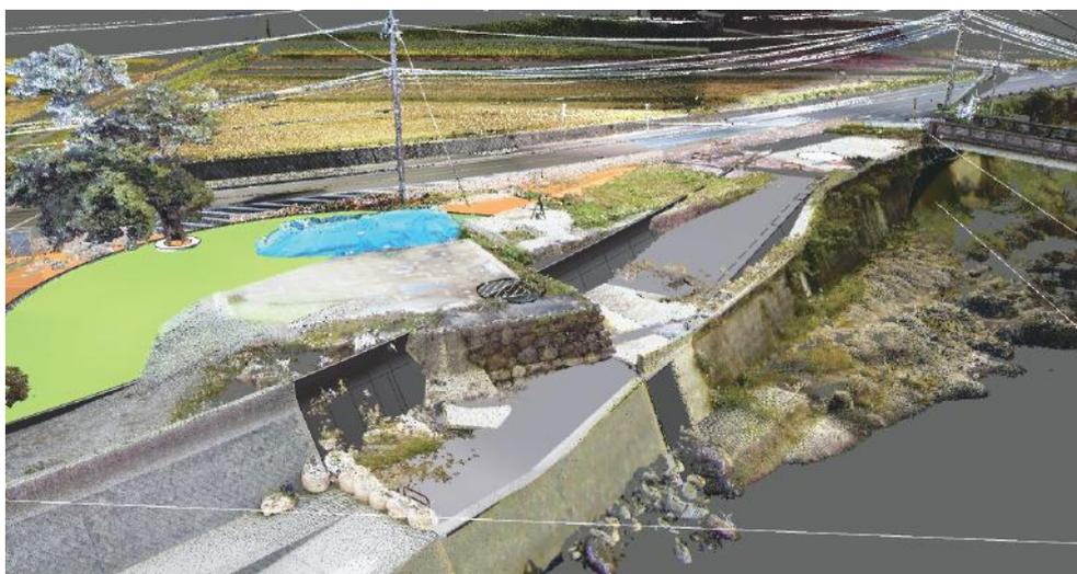
点群データとCIMモデルを合成したもの。親水護岸に通じる斜路上に既存の石垣が突き出ているのがわかる
