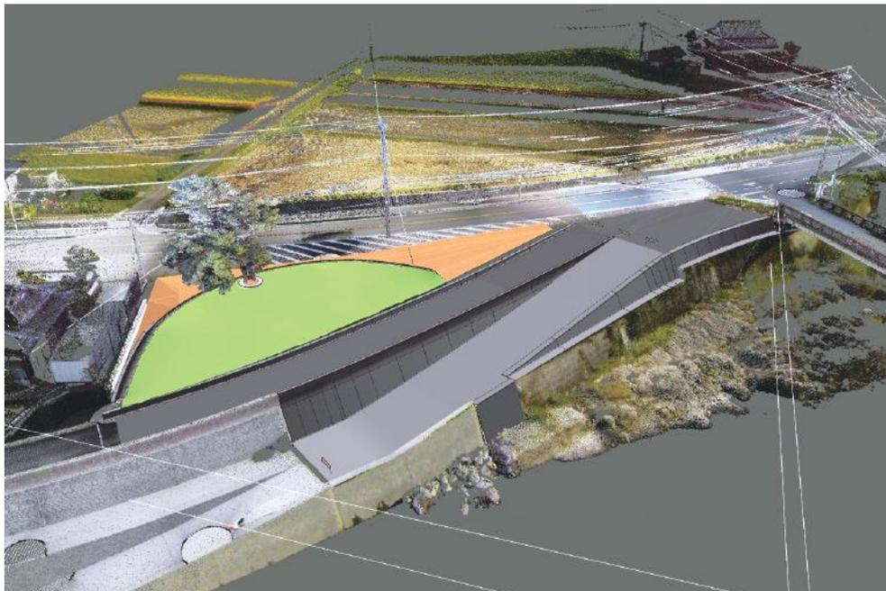
3D レーザースキャナーで計測した点群データ上に、山国川の親水区間へとつながる道路や広場などを Civil 3D で精密に CIM モデル化し、施工の品質向上や効率化に役立てた
