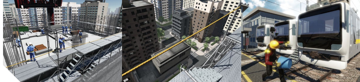
左：「安全体感 VR トレーニング」の NO.001 ではマンション建設現場における仮設足場からの墜落を体験できる 中央：ルームスケール VR を実現する HTC VIVE により、高所の危険性、安全帯の重要性を認識可能 右：「安全体感 VR トレーニング」の NO.002 では車両基地内における危険体験を通して左右確認と指差呼称の重要性を体感できる【提供：積木製作】
