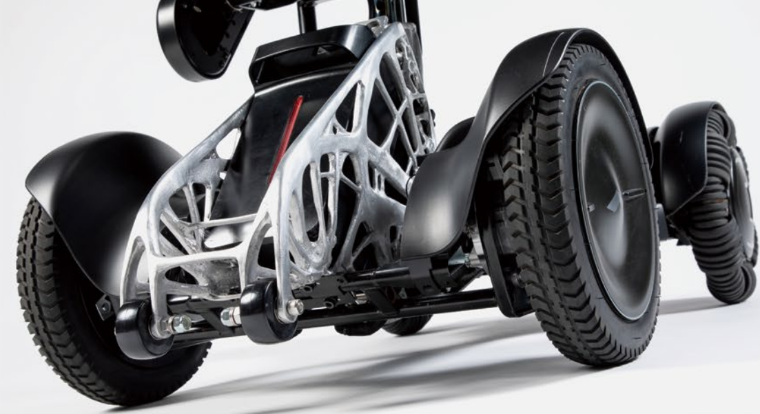
ジェネレーティブ デザインによるフレームに換装した WHILL Model C
