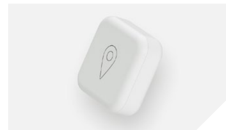
GPS BoT は縦横 5cm、厚み 1.9cm の白いボックスで、底面に充電用の MicroUSB 端子がある【提供：Bsize】
