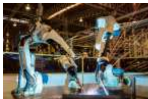
ロボットを利用した DED 加工
