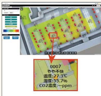
「BuildCAN」の画面。BIMモデル上に照度や温度、湿度、不快指数などが表示される（資料：安井建築設計事務所）
