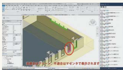
不適合の場合はBIMモデル上にマゼンタで色分け表示される（資料：清水建設）
