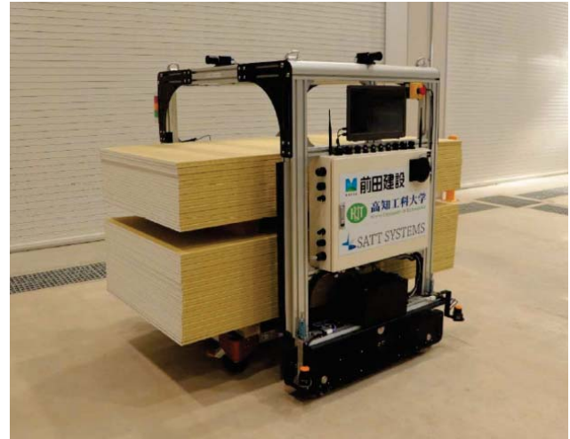
工事現場で資材を無人搬送するロボット(写真:前田建設工業)
