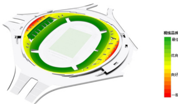
图3 体育场开闭幕式及田径比赛的三维视线分析
