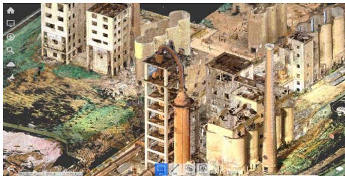
图7 主展馆工业遗址三维激光扫描点云模型
