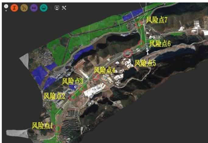
图6 西气东输管线风险点位置示意图
