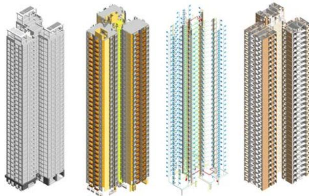
图16 10#楼围护、结构、机电、内装系统
