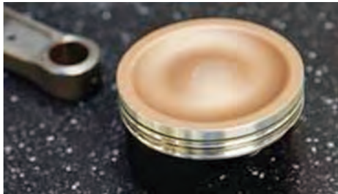
精心定制和处理所有零件（左侧是超轻活塞，右侧是车身装配件）
