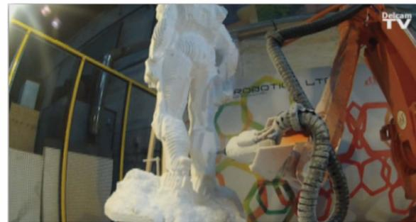
运用Delcam驱动智能机器人加工
