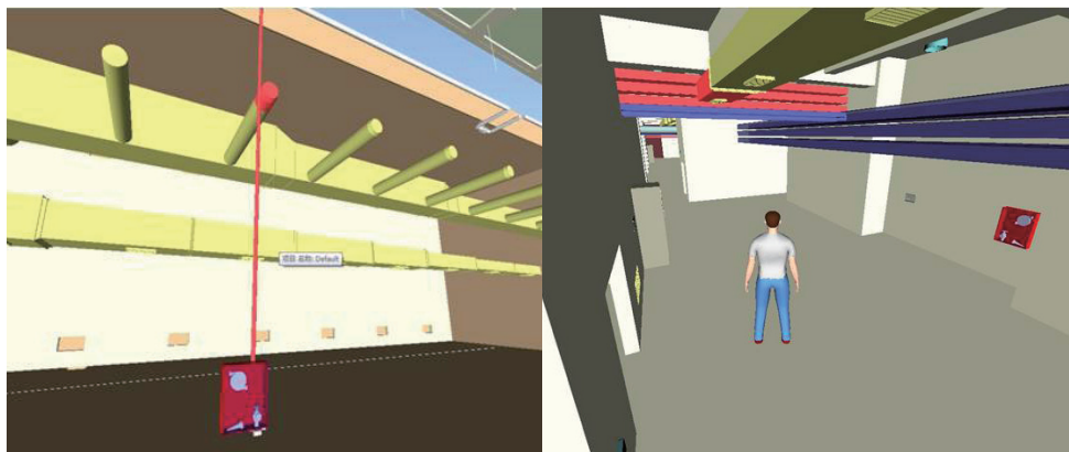
消火栓供水管与风管冲突(左图)以及风管与电缆桥架冲突(右图)
