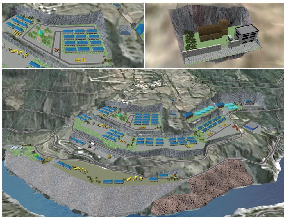
云南澜沧江黄登水电站施工营地布置模型
