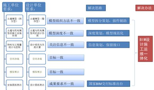
图17 BIM设计施工一体化应用思路
