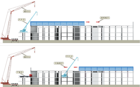
图14 钢结构吊装方案模拟
