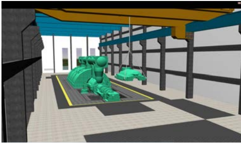
图10 汽轮机检修起吊模拟
