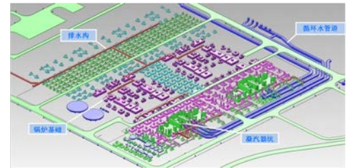
图8 万州工程地下设施可视化模型
