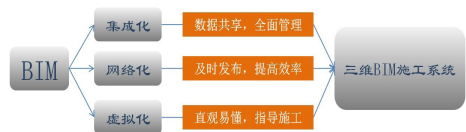
图3 观音岩三维BIM施工系统
