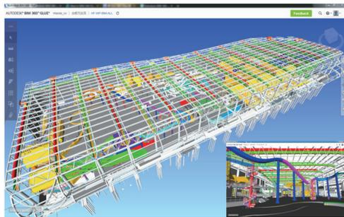
图5 项目管线模型图
