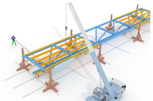
图15 三角钢桁架地面拼装
