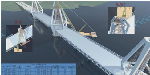
图17 桥塔节段吊装碰撞排除
