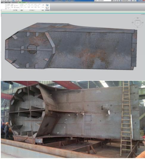
图7 Autodesk Revit 桥塔节段与工厂加工
