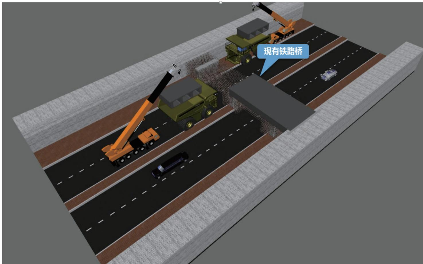
图7 桥梁拆除施工过程
