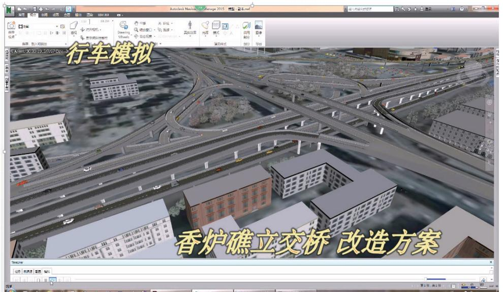
图4 香炉礁互通立交改造后模型
