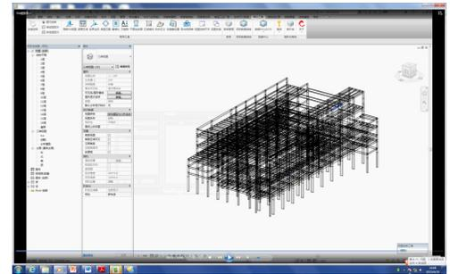
图9 结构Revit模型（导入后）
