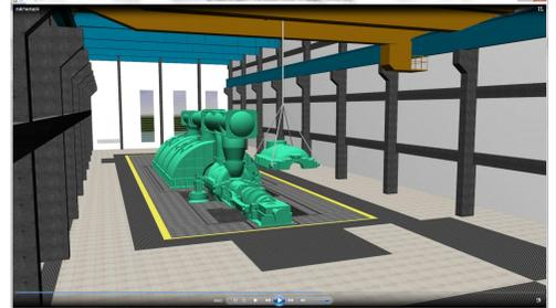
图17 汽轮机检修起吊模拟
