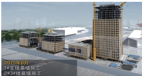
图9-2 项目施工进度模拟
