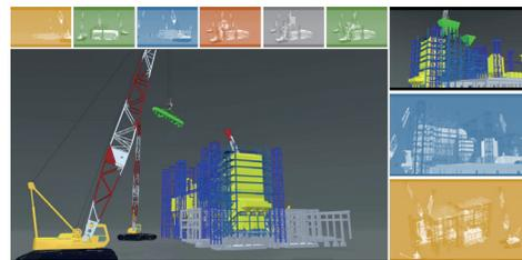
图18：4D施工模拟
