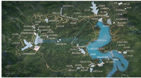
图6 电站施工总布置三维模型
