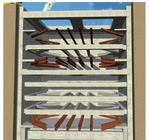
相对于传统模式，基于BIM技术的管幕温度监控系统可以结合三维模型对于历史数据、监测点位置等多个方面进行综合分析，可以更加准确、及时定位于风险的位置，使项目的安全与质量得到提升。
