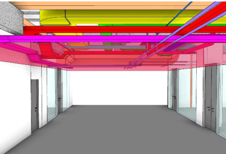
图20 商业走廊的净高优化前后Autodesk Revit局部对比
