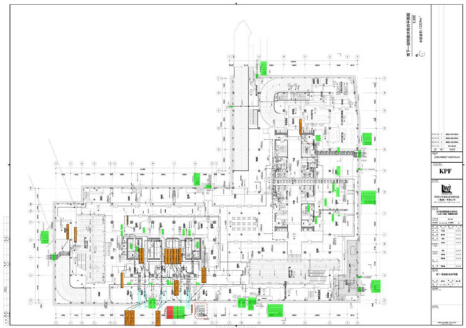
图10 结构预留洞口、套管复核优化图
