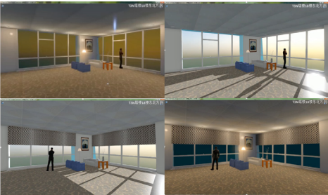
图15 室内照度及遮阳方案模拟分析
