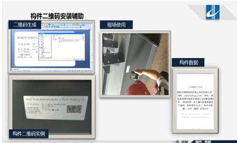
图2.4 二维码辅助构件安装
