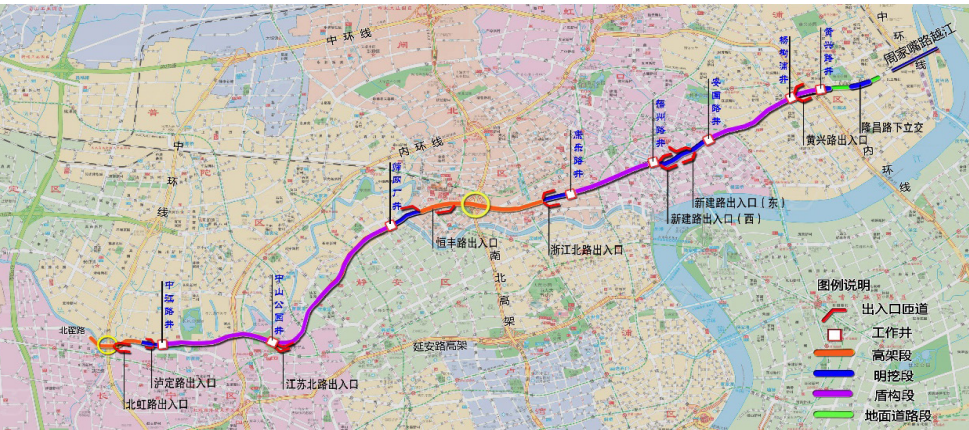
图2 北横通道新建工程概况图
