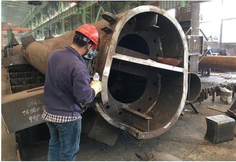
这栋塔楼的巨大弯曲结构柱在工地外制造并在施工现场组装。中国建筑第八工程局有限公司供图。
