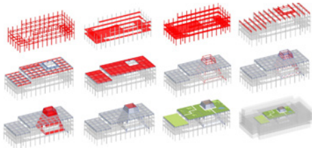
图12 中央钢屋盖主体施工模拟示意
