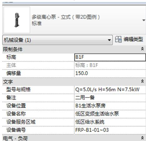
图17 设备参数一键导入
